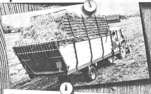
Ihr vorlaufendes Pendel-Pick-up ist 160 cm breit, hat eine hydraulische Anhebung, beim Absenken wird automatisch ein-, beim Anheben ausgeschaltet. Ihr Rechenkettenförderer hat sechs Kämme und sie sind mit einer Vorrichtung für bis zu 25 Schneidstellen ausgerüstet. Es kann mit sechs Kratzbodengeschwindigkeiten gearbeitet werden. Die Ausrüstung: Stahlprofilwände, abklappbarer Dürrfutteraufbau, Tor mit Pendelrückwand.
