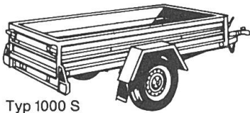
Typ 1000 S mit Kippbrücke 244×122×40 cm Nutzlast 740 kg
