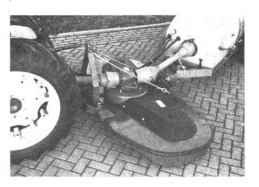
Die neuen Mulchgerätetypen Votex Kombi 180 und Votex Kombi 210 sind sowohl für Frontanbau wie auch für Heckanbau am Traktor lieferbar. Wegen seiner robusten Rahmenkonstruktion sind sie besonders zum Mähen von Obstgärten geeignet, wobei der Mäher auf Wunsch zwischen dem Traktor und der Spritze eingesetzt werden kann. Die Arbeitsbreiten betragen 1,80 m und 2.10 m.
