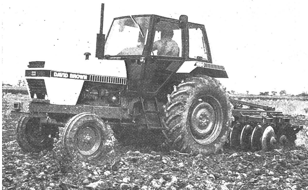
Abb. 3: Der DB 1690 mit 103 DIN-PS/76 kW ist mit einem neu konzipierten 6-Zyl.-Motor ausgerüstet. Die Blockbauweise wurde beibehalten.
