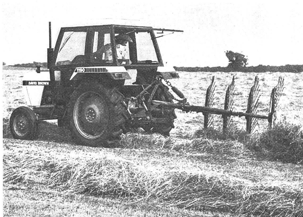
Abb. 1: Bei der David Brown 90er-Serie sind grosszügige gummigelagerte Kabinen serienmässig aufgebaut. Umsturzbügel werden auf Wunsch für bestimmte Länder geliefert.
