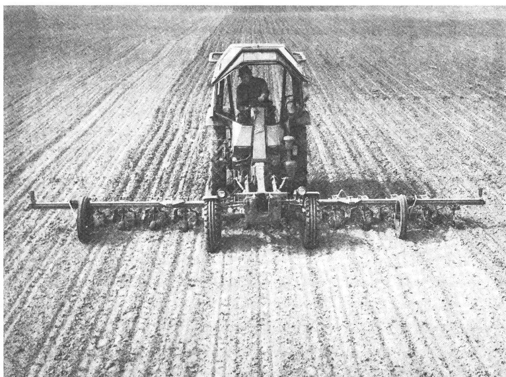
Gareförderung und Unkrautvernichtung sind das Wichtigste beim Rübenhacken. Nach Möglichkeit sollte man Anbaugeräte für die Einmannarbeit einsetzen. Das Fahrtempo beim Hacken hängt vom Entwicklungsstand der Rüben ab. Bei ganz jungen Pflanzen sollte man nicht schneller als 2 km/h fahren, da sie sonst leicht mit Erde zugedeckt werden. Bei grösseren Rüben ist dagegen ein Tempo bis 8 km/h durchaus möglich.
