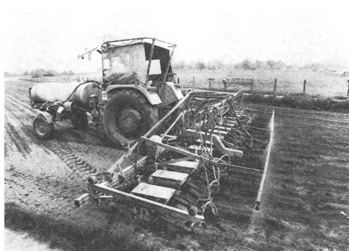
Abb. 2: Das bringt Leistung auch bei der Rübensaat: auf der vorderen Ladepritsche des Geräteträgers das Spritzfass und hinten die mehrreihige Säkombination.
