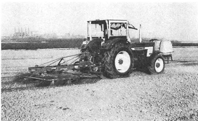
Abb. 1: Man kann bei der Frühjahrsbestellung einen Arbeitsgang einsparen, wenn man das Spritzfass mit Spritzgestänge vorne am Schlepper anbaut. Auf diese Weise wird das Unkraut ganzflächig bei der Bodenbearbeitung bekämpft.
