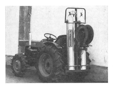
eine Beschädigung der Armaturen. Eine Schlauchtrommel kann am Transportgestell befestigt werden. Auf Wunsch kann es auch mit Rädern ausgestattet werden.
