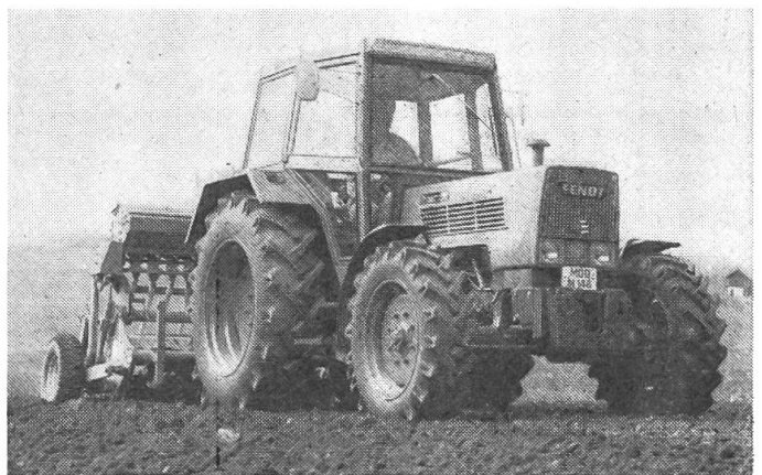
Abb. 2: Farmer 108 LS (55 kW / 75 PS) bei der Oberflächenbearbeitung im Frühjahr. Die integrierte Kabine der Farmer-Traktoren ist schall- und schwingungs isoliert auf Gummi-Elementen gelagert und bietet beispielhaften Fahrkomfort. (Werkfoto Fendt)
