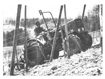
Abb. 4: Fendt-Spezialtraktor für Wein- und Hopfenbau. Kompakte, sehr schmale und besonders niedrige Bauweise mit tiefer Schwerpunktlage, Mittellenkung und moderner Fahrkomfort sind die Vorzüge der neuen Weinbau-Traktoren 200 V (38 PS / 27,5 kW) und Farmer 203 V (50 PS / 37 kW).
