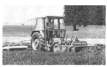
Abb. 3: Fendt-Futterbau-Geräteträger 275 GTF mit 51 kW / 70 PS. Hohe Schlagkraft beim Mähen wird mit dem Futterbau-Geräteträger erreicht. Das Front-kreiselmähwerk schneidet 2,10 m breit. Zusammen mit dem 1,80 m breiten Heck-Kreiselmähwerk wird bei einer Durchfahrt ein 3,90 m breiter Streifen gemäht. (Werkfoto)
