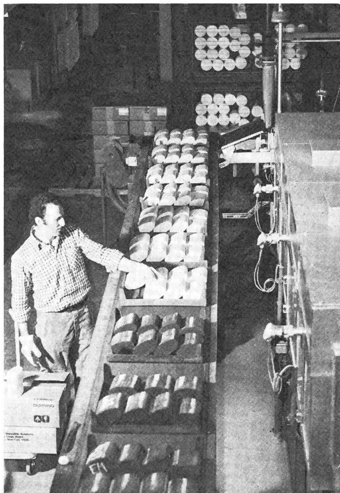
Abb. 2: Teilansicht der Anlage zur Herstellung von Autoabgaskatalysatoren im Degussa-Werk Rheinfelden. Die Anlage hat eine Kapazität von etwa 1 Million Stück pro Jahr. (Degussa-Bild)
