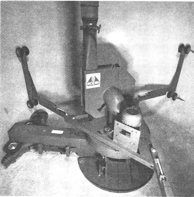
Abb. 2: Fräse mit Zentralantrieb und Dreiarm-Wandabstützung. Diese Systeme eignen sich auch für die Entnahme von Kurzschnitt-Ladewagenfutter.
