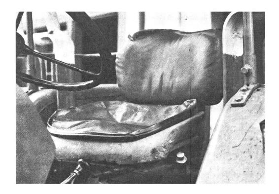
Abb. 6: Frühzeitiger Verschleiss an einem Traktorfahrersitz. (Foto FAT)
