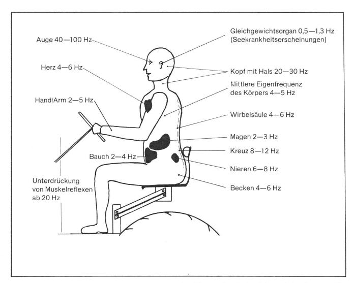
Abb. 1: Gefährliche Resonanzstellen der Organe und des Körpers des Traktorfahrers bei aufrechter Körperhaltung (nach KHD). (Hz = Hertz = Schwingungen je Sekunde).
