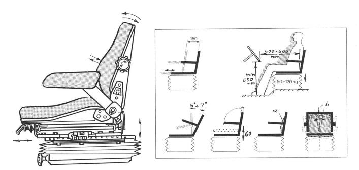
Abb. 4: Schematische Darstellung eines nach internationalen Richtlinien und ergonomischen Gesichtspunkten hergestellten Fahrersitzes mit Längsverstellung (150 mm), federunterstützter Höhenverstellung (60 mm), stufenloser Gewichtsregulierung mit Anzeige, stufenlos verstellbarer Rückenlehne und Bandscheibenwiege (a), verstellbarer Querneigung (b), stufenlos verstellbaren Armlehnen, Kunstlederbezug und atmungsaktivem, waschbarem Ueberzug. (nach KHD  $\pm$  FAT).
