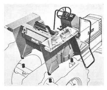
Abb. 2: Durch die Trennung des Fahrerstandes von der Grundmaschine und dessen elastische Abstützung auf Silentdämpfern konnten die Erschütterungen und Schwingungen wesentlich reduziert werden. (n. Fiat)
