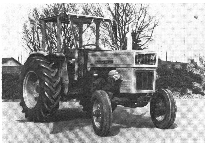
UNIVERSAL-Traktor mit Schweizer Sicherheitskabine, Gesamthöhe 2,10 m
