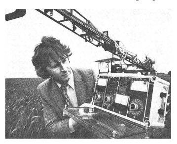
Der Fahrer wählt einfach das gewünschte Mass (z. B. 200 Liter/Hektar) und das Gerät zeigt an, ob er zu viel oder zu wenig spritzt. Er kann dann die nötigen Berichtigungen ausführen, indem er den Durchsatz oder die Schleppergeschwindigkeit ändert.
