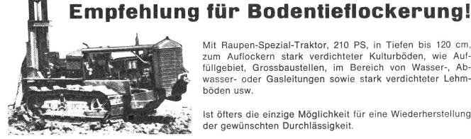
Mit Raupen-Spezial-Traktor, 210 PS, in Tiefen bis 120 cm, zum Auflockern stark verdichteter Kulturböden, wie Auffüllgebiet, Grossbaustellen, im Bereich von Wasser-, Abwasser- oder Gasleitungen sowie stark verdichteter Lehmböden usw.
