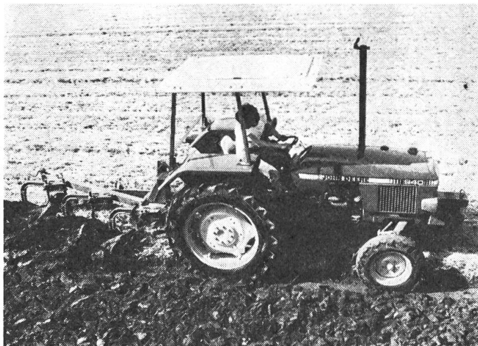
Abb. 1: John Deere Traktor 940: 3-Zylinder John Deere Dieselmotor, 2940 ccm Hubraum 32 kW (44 PS), Drehmomentanstieg 17,6%, Muffenschaltgetriebe mit Lastschaltstufe, ölgekühlte Scheibenbremsen, innenliegende Planetenend-antriebe.
