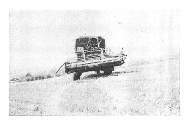
Abb. 4: Beim Hangmähdrescher wird mit Hilfe einer besonderen Fahrwerkkonstruktion die Maschine in Schichtenlinie und in Fallinie automatisch geführt. Ist der Bauer gewillt, wegen des höheren Anschaffungspreises der Maschine einen höheren Dreschpreis zu bezahlen?
