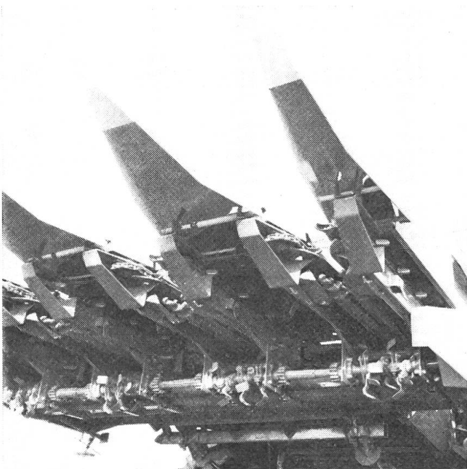
Abb. 5: Durch Unterbauhäcksler am Maispflücker wird eine Zerkleinerung des Maisstrohs erreicht. Ein weiterer Vorteil ist, dass nach der Ernte «sauberer» gepflügt werden kann.
