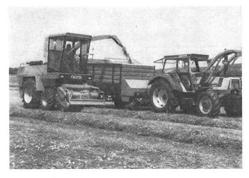
Abb. 3: Selbstfahrende Feldhäcksler mit Allradantrieb und wahlweisem Vorbau für die Silomais- und Zukkerrübenernte usw. sind für den Lohnunternehmer gedacht.
