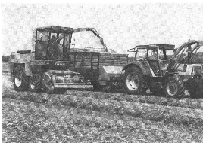
Abb. 3: Selbstfahrende Feldhäcksler mit Allradantrieb und wahlweisem Vorbau für die Silomais- und Zuckerrüben-ernte usw. sind für den Lohnunternehmer gedacht.
