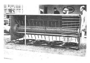
Abb. 1: Die neueste Tendenz im Futteraufbereiten geht dahin, die Halme lediglich anzureiben, denn die Spannung des Halmes soll erhalten bleiben. Das Futter darf nicht zusammensacken.
