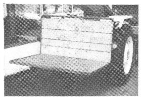
Ladebrücke zu Traktoren, zweckmässig und stark, Ladefläche 140 x 100 cm, Tragkraft 400 kg.
