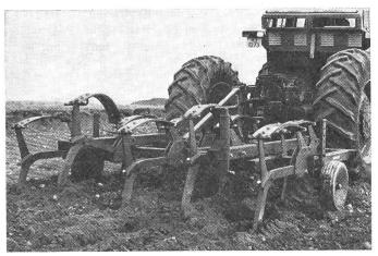
Der Automat-Grubber bricht die Pflugsohle auf, so dass der Boden gelüftet wird. Die Bodenstruktur und die Ernteerträge werden verbessert.
