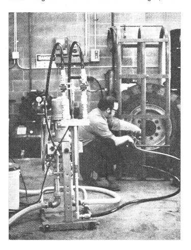
bles, gummiartiges Material ergeben. Exakte Dosierung der zwei Komponenten, gründliche Vermischung und Injektion des gemischten Materials in den Reifen durch das Reifenventil ist mit der Graco-Hydra-Cat-Anlage einfach und schnell zu erledigen.
