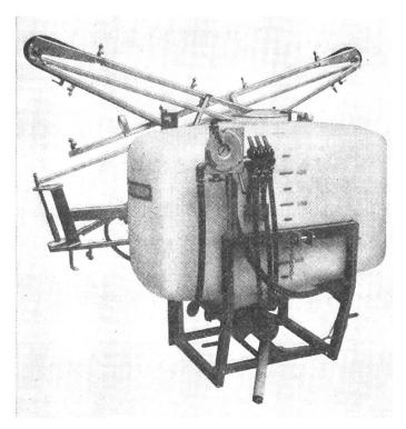
Abb. 2: Agroport-Feldspritze mit Dreikolben-Membran-Pumpe (95 1/20 bar).
