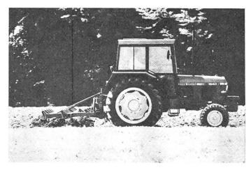
John Deere Traktor 1640: 4-Zylinder John Deere Dieselmotor, 3920 ccm Hubraum 46 kW (62 PS), Drehmomentanstieg 16,5%, Synchrongetriebe, ölgekühlte Scheibenbremsen, innenliegende Planetenendantriebe. Wahlweise: Fahrer-Sicherheits-Kabine mit hydrostatischer Lenkung, mechanischer Frontantrieb, Selbstsperr-Differential, Power-Synchron-Getriebe, Kriechgang.
