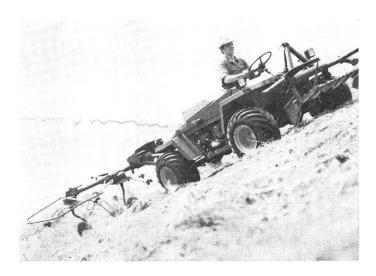
REFORM Metrac 2002, der moderne Bergmähheuer für den vielseitigen Einsatz mit Doppelmesser-Frontmähwerk und Kreiselheuer. Höchste Sicherheit durch extrem breite Spur, tiefen Schwerpunkt, Allradantrieb und breite Terrabereifung. Hohe Kraftreserven durch leistungsstarken 22-PS-Dieselmotor (16,2 kW).
