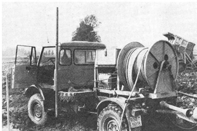
Abb. 2: Der Antrieb des Gerätes erfolgt durch einen Unimog-Motor.
