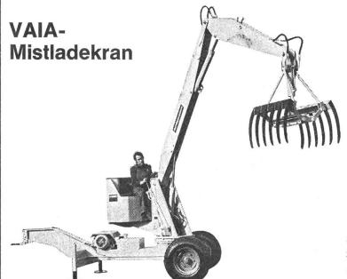
Armlänge von 4,5-7 m, Mistgabel, vollhydraulisch, Bereifung 10 x 15, mit grosser Hydraulik-Pumpe, an Zapfwelle oder mit Gelenkwelle, Diesel- oder Elektromotor. Jede Maschine kann auch mit Tieflöffel oder Greifer ausgerüstet werden.
