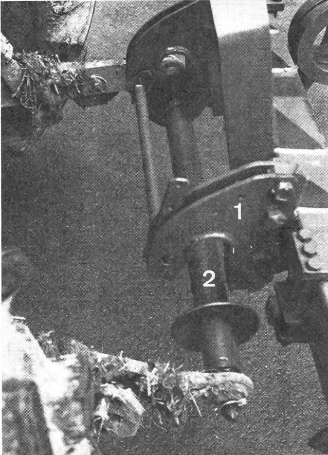
Abb. 2: Die geräteseitig montierten Fanghaken (1) und die demontierbare Tragachse (2) ermöglichen das Kuppeln der Unterlenker, ohne vom Traktor zu steigen.
