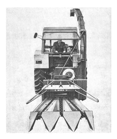
Scheibenrad setzt die gesamte Zapfwellenkraft voll in Häckselleistung um. Der heck- oder frontangebaute Häcksler ermöglicht ein unbehindertes Arbeiten beim «Durchstechen» oder Grenzmähen. Wirksame Sicherheitseinrichtungen schützen den MEX V vor Ueberlastung und Fremdkörpern. Bei gleicher Leistung kostet er kaum die Hälfte eines Selbstfahrers.
