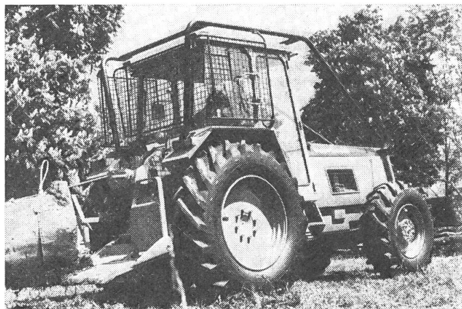
Forstraktor CEMET SM 255 mit starrem Fahrgestell und 4-Rad-Antrieb (Leistung: 65,5 kW (88 PS)).
