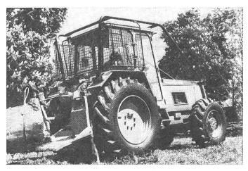
Forsttraktor CEMET SM 255 mit starrem Fahrgestell und 4-Rad-Antrieb (Leistung: 65,5 kW (88 PS).
