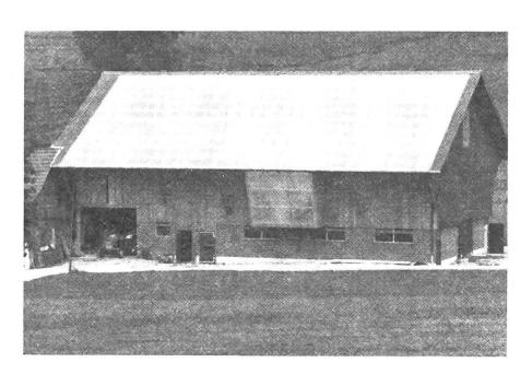
Abb. 8: Richtig konzipierte Warmluftkollektoren bringen eine spürbare Reduktion der Belüftungszeit und damit des Stromverbrauches. (Foto H. Meier)
