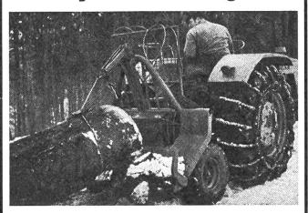
In einigen Minuten an jeden Traktor im Dreipunkt montierbar. Kein Ueberschlagen des Traktors, da die Last auf die beiden Räder des Rückewagens abgestützt wird.
