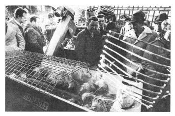
Abb. 2: Bei diesem Reiniger und Schnitzler werden die geschnitzelten Rüben mittels hochfördernder Schnecke in Karren, Frontladerschaufel oder Futterwagen entleert.
