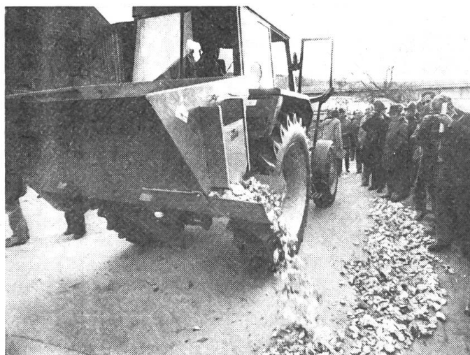
Abb. 1: Dieser Multifeed (er fasst rund 400 kg Rüben) wird beim Beladen nach unten gekippt und ins Rübenlager geschoben. Ganze Rüben werden beim Rausfördern mittels Schnecke geschnitzelt und können über Zapfwelle dosiert werden.
