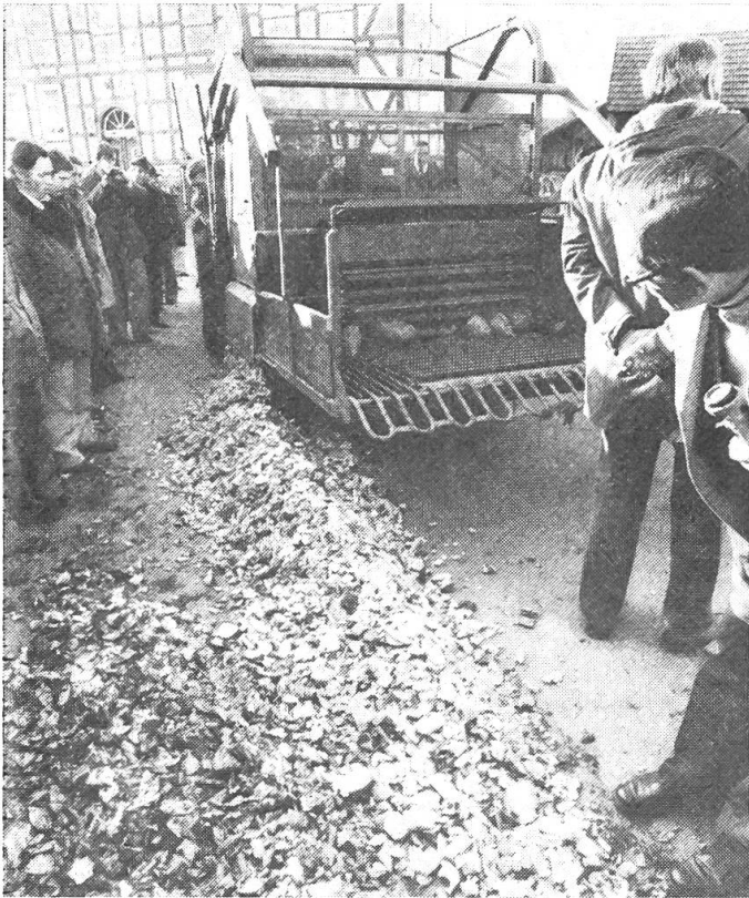
Abb. 5: Dieses Kombigerät, auch für Silageentnahme aus dem Fahrsilo geeignet, kann die Rüben aus dem Lager aufnehmen, sie in einer Rübenschnitzeltrommel schnitzeln und seitlich in den Trog entleeren. In einem Arbeitsgang werden 2,5 cbm Rüben geladen, geschnitzelt und dosiert gefüttert. Hersteller: H.W. Dreyer, 4515 Wittlage.
