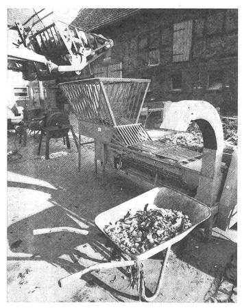
Abb. 6: Dieser kombinierte Rübenreiniger u. -schnitzler wird über einen Trichter mit dem Frontlader beschickt. Ein Auswurfschnitzler füllt Karren oder Futterwagen mit Rübenschnitzel.
