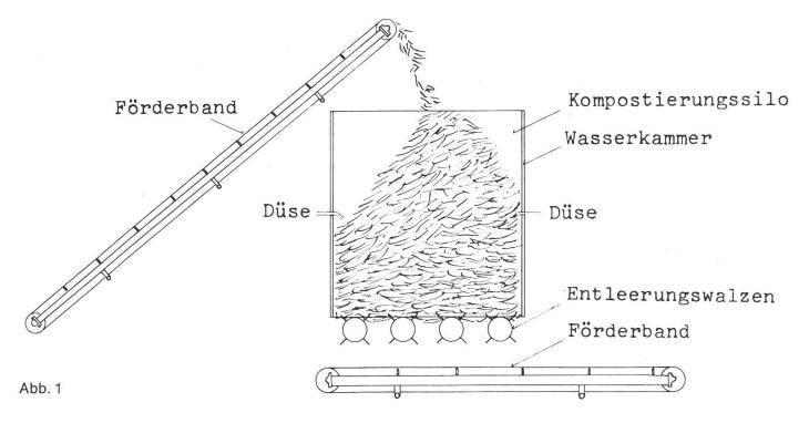
Kompostierung stark beschleunigt wird. Dabei erhält man pro Wandfläche eine grosse Wärmeentwicklung. Die so erzielte Wassertemperatur ist bedeutend höher als beim Verfahren ohne Durchlüftung.
