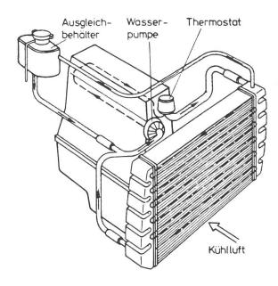
genlinien von oben, sich von der einen Seite nach der andern wiederholt wendend, nach unten. Hierdurch wird die Kühlwirkung verbessert. Diese Art von Kühler erkennt man an den seitlich angebrachten Wasserkästen
