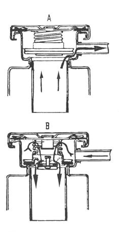
Wasser gefüllt und frei von Luft oder Dampf ist. Der Ausgleichsbehälter ist zweckmässigerweise aus durchscheinendem Kunststoff gefertigt, um eine leichte Kontrolle des Wasserstandes von aussen zu ermöglichen.
