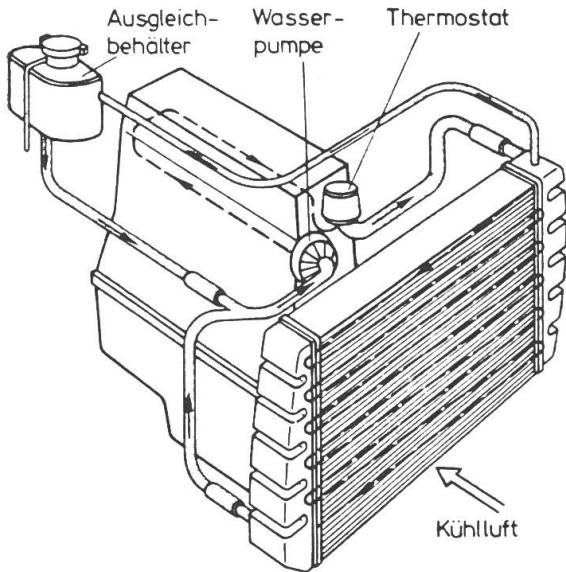
genlinien von oben, sich von der einen Seite nach der andern wiederholt wendend, nach unten. Hierdurch wird die Kühlwirkung verbessert. Diese Art von Kühler erkennt man an den seitlich angebrachten Wasserkästen
