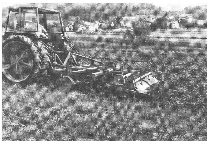
Abb. 2: Die Kombination des Grubbers mit einer Bodenfräse ermöglicht, das Feld in einem Arbeitsgang saarfertig vorzubereiten. Diese Kombination erfordert allerdings Traktoren über 60 kW Motorleistung.
