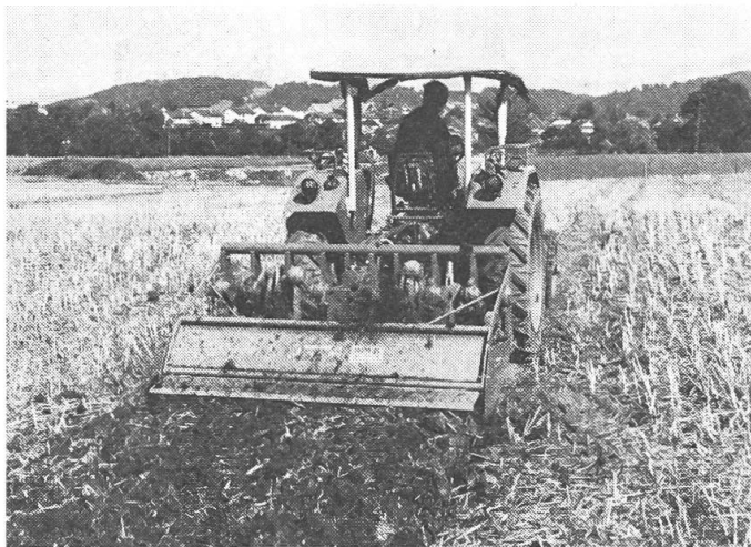
Abb. 3: Die Spatenmaschine mit Pendelspaten bestellt den Boden ohne Bildung einer Schmierschicht.
