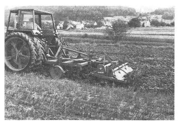
Abb. 2: Die Kombination des Grubbers mit einer Bodenfräse ermöglicht, das Feld in einem Arbeitsgang saatfertig vorzubereiten. Diese Kombination erfordert allerdings Traktoren über 60 kW Motorleistung.
