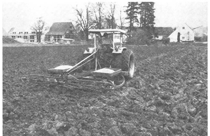
Abb. 5 und 6: Für die Saatbeetvorbereitung und Saat nach pflugloser Bestellung sind Geräte und Maschinen mit verstopfungsunempfindlichen Arbeitswerkzeugen zu verwenden. Auf den Abbildungen 5 und 6 erkennt man eine Spatenrollegge und eine Scheibensämaschine.
