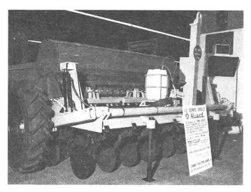
Abb. 7: Für das Verfahren «Direktsaat» werden Spezialsämaschinen (auf der Abbildung Marke Huard) angeboten.
