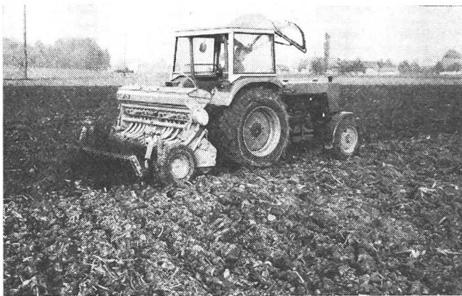
Abb. 8: Die Minimalbodenbearbeitung wird mit einer Frässämaschine ausgeführt. Dieses Verfahren hat sich vor allem für den Zwischenfruchtbau und für den Weizenbau bewährt.
