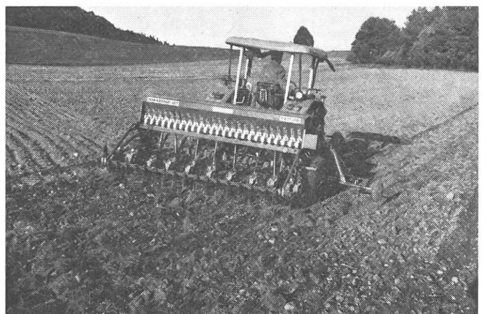
Abb. 5 und 6: Für die Saatbeetvorbereitung und Saat nach pflugloser Bestellung sind Geräte und Maschinen mit verstopfungsunempfindlichen Arbeitswerkzeugen zu verwenden. Auf den Abbildungen 5 und 6 erkennt man eine Spatenrollegge und eine Scheibensämaschine.
