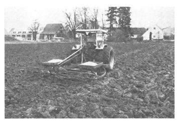
Abb. 5 und 6: Für die Saatbeetvorbereitung und Saat nach pflugloser Bestellung sind Geräte und Maschinen mit verstopfungsunempfindlichen Arbeitswerkzeugen zu verwenden. Auf den Abbildungen 5 und 6 erkennt man eine Spatenrollegge und eine Scheibensämaschine.
