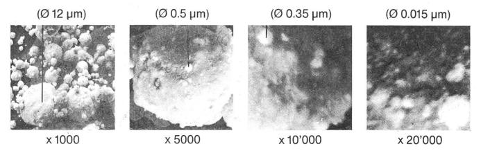
Der kleinste hier sichtbare Partikel ist ca. 150 Angström (0.015 µm) gross! Auch in Atomgrösse ist Lubrifilm eine einheitlich stabilisierte, heterogene Mischung.
