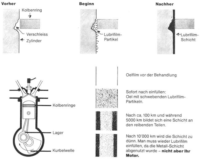
Abb. 2: Entwicklungsvorgang der Schutzschicht
