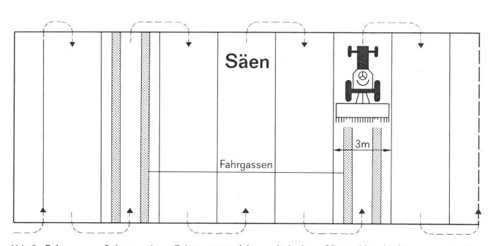
Abb. 2: **Fahrgassen.** Schema eines Fahrgassenverfahrens bei einer Sämaschinenbreite von 3 m abgestimmt auf eine Feldspritze mit 12-m-Balken sowie einem 2-Scheiben-Schleuderdüngerstreuer (Schema abgeändert nach Irla, FAT, 1978).
