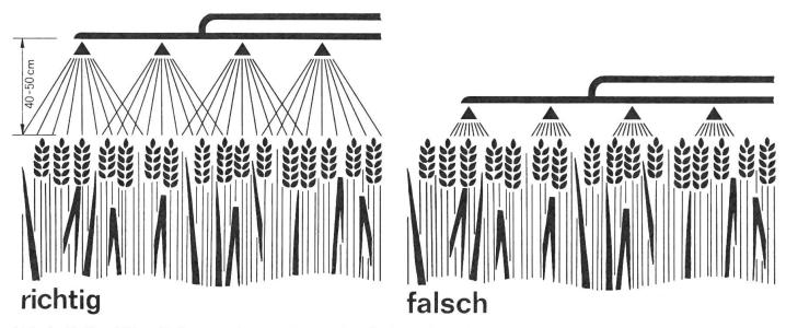
Abb. 1: Balkenhöhe. Bei zu geringem Abstand zwischen den Düsen und den obersten Aehren können Spritzlücken entstehen, welche später zu Aehrenbefall führen.
