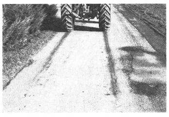
Abb. 34: Bremsprobe mit richtig eingestellten Bremsen.
