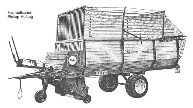
Gleichmässig arbeitendes, robustes Schubstangen-Fördersystem. Nur ein Viertel der Messer schneiden gleichzeitig. Verschiedene Reifendimensionen, auf Wunsch Tandemachse.
