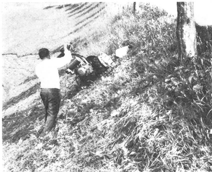
Abb. 2: Die Hangtauglichkeit der Motormäher hat heute diejenige der Bedienungsperson erreicht.
