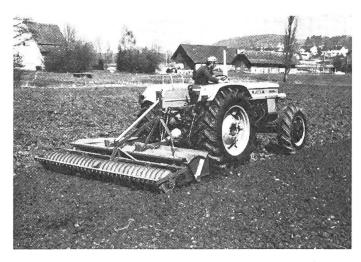
Abb. 11+12: Der Einsatz von zapfwellengetriebenen Geräten, wie Bodenfräse oder Kreiselegge, ist insbesondere in schweren Böden angezeigt.
