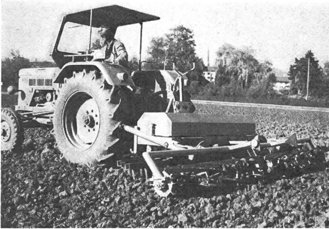
Abb. 14: Die Einsatzmöglichkeiten einer Rüttelegge beschränken sich auf leichte bis mittelschwere Böden, also dort, wo die gezogenen und billigeren Geräte ebenfalls verwendbar sind.
