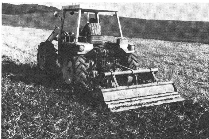
Abb. 5+6: Für die pfluglose Bodenbearbeitung haben sich besondere Meisselgrubber und Pendelspantenmaschinen bewährt.
