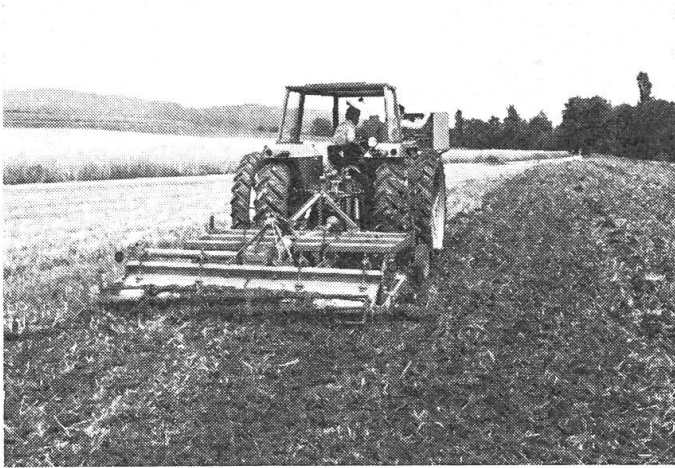
Abb. 7+8: Grubber aller Art und Scheibeneggen können zur Stoppelbearbeitung und auch bedingt zur Saatbettherstellung eingesetzt werden. Bei der Ausrüstung des Grubbers mit einer Nachlaufräse kann das Feld praktisch in einem Arbeitsgang saatkünftig vorbereitet werden. Eine solche Kombination erfordert allerdings Traktoren über 80 PS Motorleistung.
