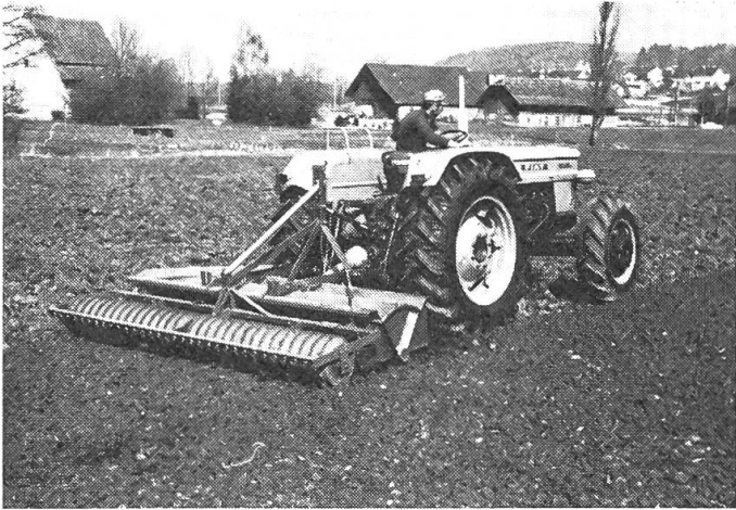
Abb. 11+12: Der Einsatz von zapfwellengetriebenen Geräten, wie Bodenfräse oder Kreiselegge, ist insbesondere in schweren Böden angezeigt.
