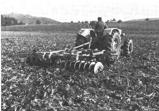
Abb. 7+8: Grubber aller Art und Scheibeneggen können zur Stoppelbearbeitung und auch bedingt zur Saatbettherstellung eingesetzt werden. Bei der Ausrüstung des Grubbers mit einer Nachlaufräse kann das Feld praktisch in einem Arbeitsgang saatkünftig vorbereitet werden. Eine solche Kombination erfordert allerdings Traktoren über 80 PS Motorleistung.
