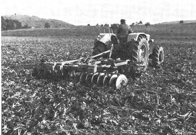
Abb. 7+8: Grubber aller Art und Scheibeneggen können zur Stoppelbearbeitung und auch bedingt zur Saatbettherstellung eingesetzt werden. Bei der Ausrüstung des Grubbers mit einer Nachlaufräse kann das Feld praktisch in einem Arbeitsgang saattfertig vorbereitet werden. Eine solche Kombination erfordert allerdings Traktoren über 80 PS Motorleistung.
