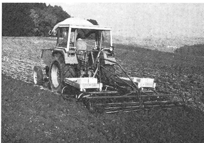
Abb. 9: Eine Spatenrollegge wird vor allem für die Saatbettvorbereitung im Herbst mit Erfolg eingesetzt.
