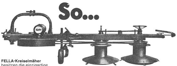
besitzen die einzigartige, stufenlose Schnitthöhen-Schnellverstellung mittels obenliegendem Handrad. Die drehbaren Teller gleiten über alle Böden und schonen die Grasnarbe. Ein Doppelprofil-
