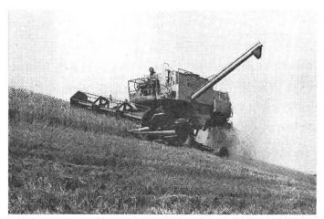
Abb. 5: Claas Do. 85 H mit Vollhang-Ausgleich. Bis zu bestimmten Geländeneigungen bleiben die Dreschorgane sowohl in der Längs- wie auch in der Querachse immer in horizontaler Lage. Sicherheitssperrventile sorgen bei allen Hangmähdreschern dafür, dass sich die Maschine bei einem Leitungsbruch nicht absenken kann.
