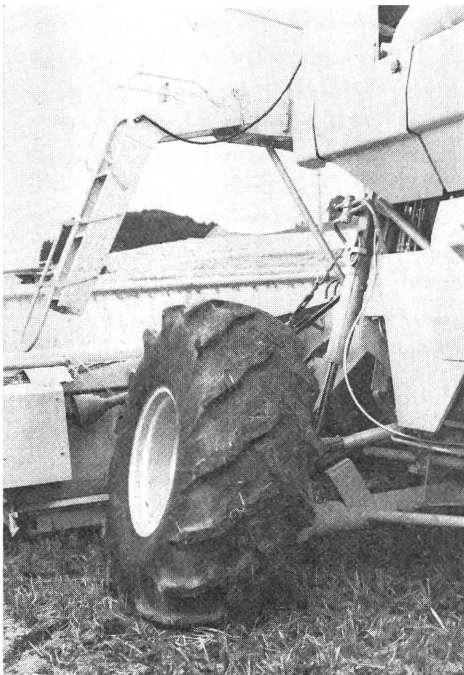
Abb. 6: Pendelnd aufgehängte Vorderachse bei Mähdrescher mit Vollhang-Ausgleich (New Holland). Er-sichtlich sind auch der Hydraulikzylinder und ein Drahtseilzug für die Schneidwerkführung.
