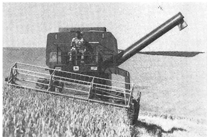
Abb. 2: John Deere 965 H mit Seitenhang-Ausgleich bis 20%. Durch eine Parallelogrammführung bleiben auch die Hinterräder innerhalb des Regelbereichs immer in vertikaler Stellung.
