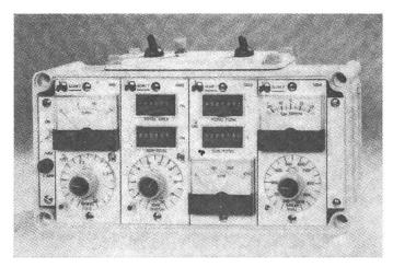
Abb. 1: Elektronische Regeleinheit zur weitgehend automatischen Einhaltung einer vorgegebenen Ausbringmenge. (Agmot)
