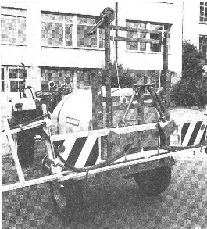
Abb. 4: Spritzbalken mit Pendelausgleich und Höhenverstellung über Seilwinde. (Birchmeier)
