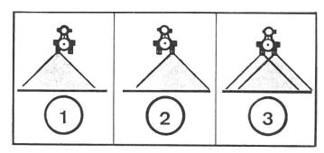
Abb. 5: Schematische Darstellung der Arbeitsweise einer Doppeldüse:
