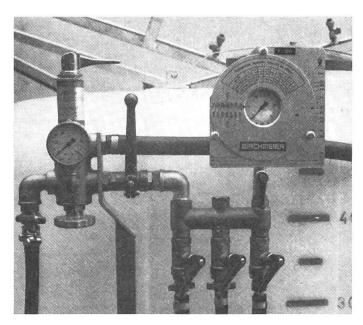
Abb. 3: Bedienungsarmatur zum direkten Ablesen des einzustellenden Druckes für eine bestimmte Litermenge pro Hektare bei einer vorgegebenen Fahrgeschwindigkeit. (Birchmeier)
