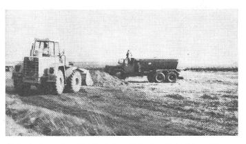
Abb. 1: Aus der Feldmiete wird der Scheideschlamm durch Lohnunternehmer aufgeladen und durch Spezialstreuer ausgebracht.
