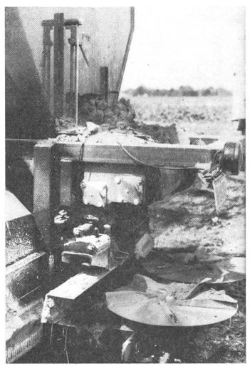
Abb. 2: Zwei rotierende Prallteller sorgen bei diesen Spezialstreuern für ein gleichmässiges Streubild des auf die Ackerflächen ausgebrachten Scheideschlammes.
