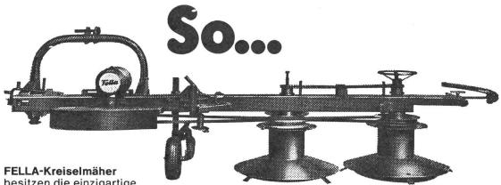
besitzen die einzigartige, stufenlose Schnitthöhen-Schnellverstellung mittels obenliegendem Handrad. Die drehbaren Teller gleiten über
