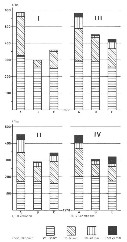
Abb. 3: Steinbesatz und -fraktionen in Kies- und Lehmböden je nach Entsteinungsverfahren A= unbehandelt B= Steinsammler C= Steinbrecher
