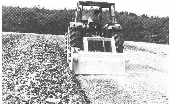
Abb. 2: Oben: Infolge der geringen Arbeitstiefe des Steinbrechers (2–4 cm) mussten die Steine vorgängig mit einem Steinsammler bis zu einer Tiefe von 10–15 cm auf die Oberfläche gefördert werden.
