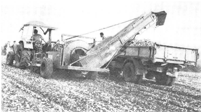
Abb. 1: Die Entsteinung des schwersiebbaaren Jura-Lehmbodens konnte nur beim Einsatz des Steinsammlers mit leistungsfähigen Sieborganen (Sieband und -trommel) befriedigen.
