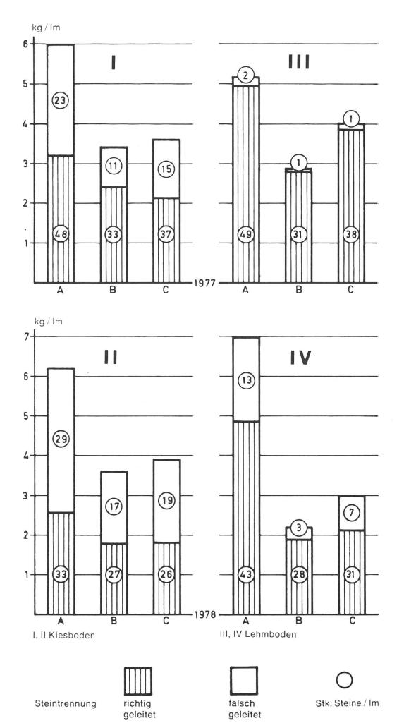
Abb. 7: Durch den Vollernter aufgenommene Steinmengen je Laufmeter, in Abhängigkeit der Entsteinungsverfahren: A = unbehandelt B = Steinsammler C = Steinbrecher
