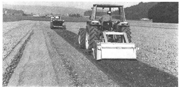
Abb. 1: Die Entsteinung des schwersiebbaaren Jura-Lehmbodens konnte nur beim Einsatz des Steinsammlers mit leistungsfähigen Sieborganen (Sieband und -trommel) befriedigen.
