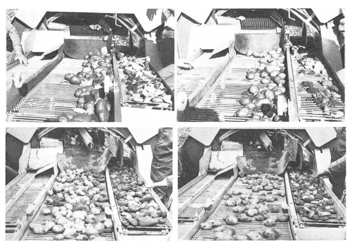
Abb. 8: Bei der Vollernte bewirkte die Steinbeseitigung eine geringere Steinaufnahme und eine höhere Trenngenauigkeit durch die Gummifingerbänder (rechts, oben: Lehmboden, unten: Kiesboden).
