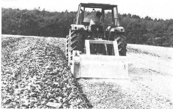
Abb. 2: Oben: Infolge der geringen Arbeitstiefe des Steinbrechers (2–4 cm) mussten die Steine vorgängig mit einem Steinsammler bis zu einer Tiefe von 10–15 cm auf die Oberfläche gefördert werden.
