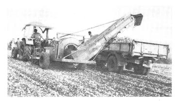
Abb. 1: Die Entsteinung des schwersiebbaren Jura-Lehmbodens konnte nur beim Einsatz des Steinsammlers mit leistungsfähigen Sieborganen (Siebband und -trommel) befriedigen.
