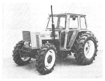
Der neue FIAT-Traktor 670 mit 12 Vorwärts- und 3 Rückwärtsgängen. Planetenvorderachse. Servolenkung. Speziell kräftige, hydraulische, nach vorn klappbare Motorhaube, daher sofort freier Zutritt zum Motor.
