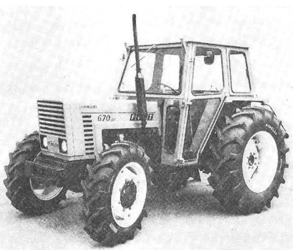
Der neue FIAT-Traktor 670 mit 12 Vorwärts- und 3 Rückwärtsgängen. Planetenvorderachse. Servolenkung. Speziell kräftige, hydraulische, nach vorn klappbare Motorhaube, daher sofort freier Zutritt zum Motor.
