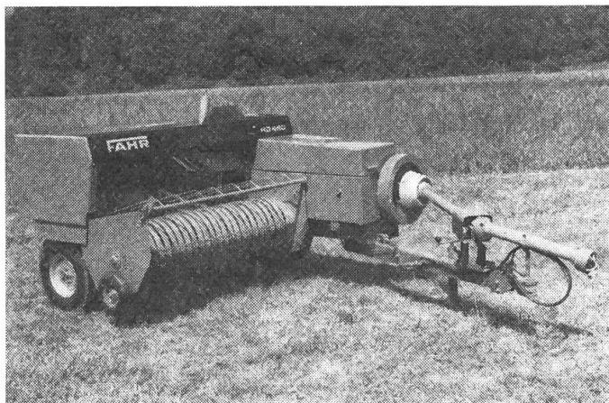
Auch bei den FAHR-Hartballenpressen gibt es zwei neue Modelle. Merkmale: erhöhte Leistung, hydraulische Pickup-Aushebung, hydraulische End- und Verriegelung der Deichselausschwenkung, zentrale Schmierung für den Knüpfbereich. Das gross dimensionierte Pick-up weist eine Aufnahmehöhe von 1.80 m auf.
