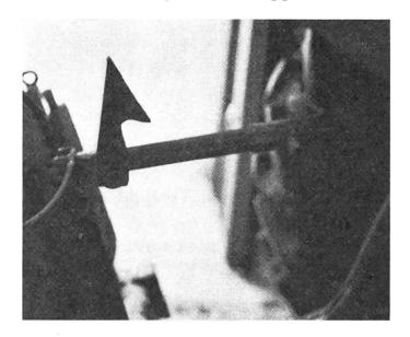
Der Anbau vom Brüggli kann sehr zeitraubend sein, wenn der normale Oberlenker verwendet und in der Länge immer verstellt werden muss (Foto Nr. 3). Ich habe diesem Uebel abgeholfen mit zwei Gelenkwellenrohren, welche beidseitig mit einem Loch für Steckbolzen versehen sind. Zur Sicherung der Arretierung dient ein Ring, welcher um Rohr und Haken gelegt wird.
