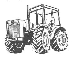
Dank Allradlenkung — Allradantrieb — Hydrostatischer Knicklenkung — wurden folgende Pluspunkte hervorgehoben: Unübertroffene Wendigkeit auf engstem Raum (Wenderadius 3,4 m), enorme Zugleistung ohne Schlupf, auch bei kritischen Bodenverhältnissen, stets passt er sich Geländeunebenheiten voll an — dabei lässt er sich noch im tiefsten Morast wie PW auf Strasse lenken. Die Differentialsperren auf allen 4 Rädern werden gemeinsam mit einem Hebel betätigt. Sein Motorzapfwelle ist vorne
