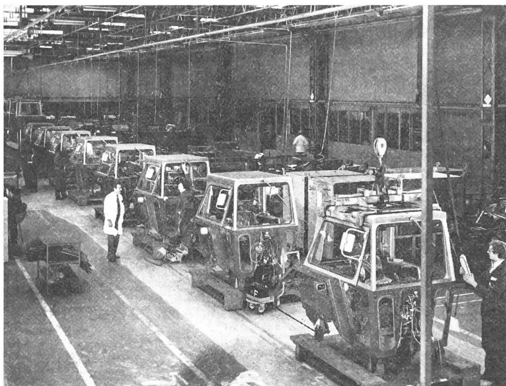
Abb. 3: Hier werden Getriebe, Hinterachsen und Hydrauliken zusammen- gebaut.
