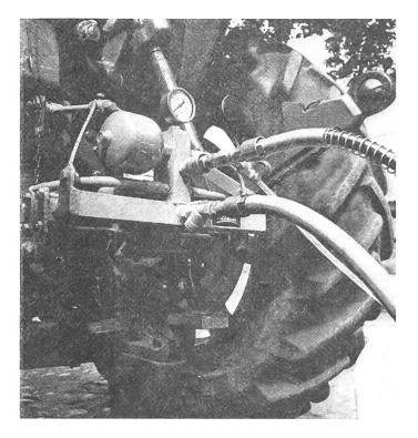
Gerät hat einen Arbeitsdruck von 150 bar bei 840 Liter Wasser pro Stunde.
