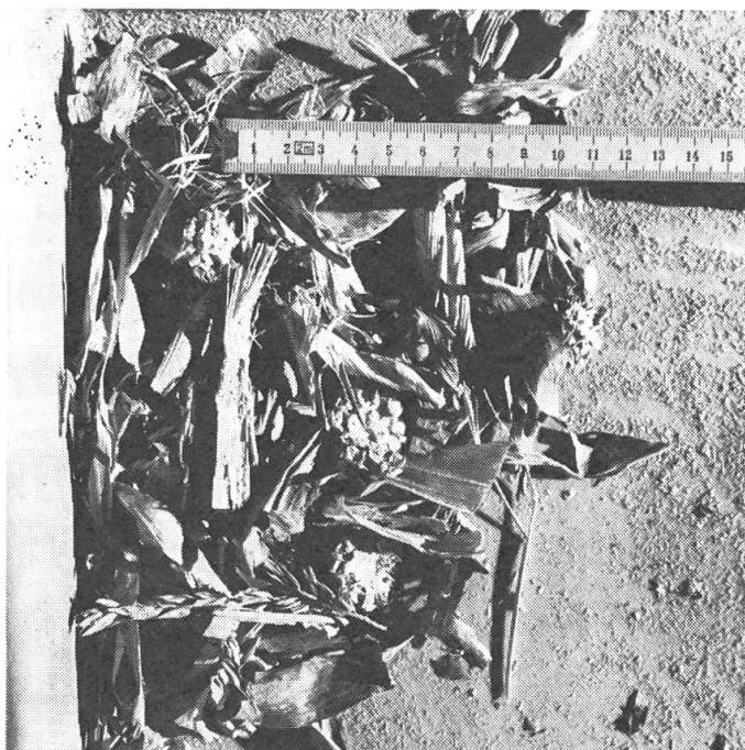
Abb. 1: Pflanzenteile, die beim Absieben das Sieb mit 20 mm Lochdurchmesser nicht passierten. Links: Maschine einwandfrei gewartet. Rechts: von gleicher Maschine, doch war der Spalt zwischen Häckselmesser und Gegenschneide etwa 1.5 mm breit. Bei der Probe rechts war der Anteil an groben Pflanzenteilen dreimal so gross wie links.
