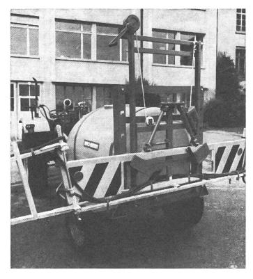
Daneben sind verschiedene Modelle der AGROPORT-Aufsattelspritzen ausgestellt und zwar angefangen vom BIRCHMEIER-Preisschlager AGROPORT-J 500 I mit Dreikolben-Membranpumpe, 100 I/20 bar bis zum Modell für höchste Ansprüche in bezug auf Technik und Leistung mit den leistungsstarken BIRCHMEIER-Kolbenpumpen.
