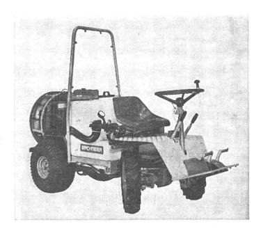
**geschlossen.** Die Düsen sind einzeln abstellbar und mit Anti-Tropf-Ventilen ausgerüstet.
