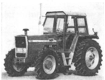
MF 1114 Allrad und MF 1134 Allrad sind ausgerüstet mit Allrad-Differentialsperre. Integrierte und lärmgedämpfte Luxus-Sturzkabine mit zwei Türen und Dachluke, Heizung, Frischluftzufuhr und getönte Scheiben sind Standard-Ausrüstung.
