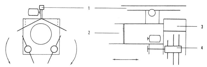
Abb. 8: Teleskopanlage mit verstellbarem Blech und Haspel
