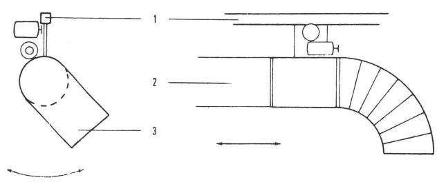
Abb. 7: Teleskoprohranlage mit Schwenkbogen mit Endverzögerung
