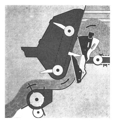
Abb. 2: Fördermechanismus eines Erntewagens mit eingebautem Silierschneidwerk.
