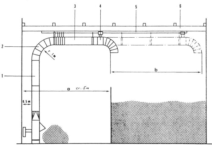
Abb. 10: Teleskopanlage mit Schwenkbogen
