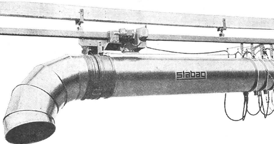
**NEU:** Sinnvolle, elektronisch gesteuerte Rückstreu-Vorrichtung für Heustöcke ohne Vorraum (Einbaulänge).
